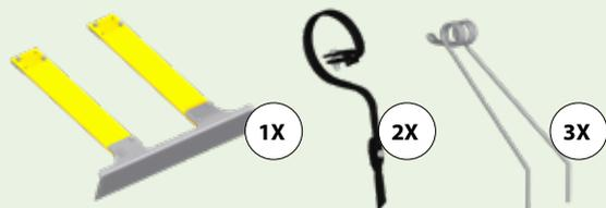
Модель Scariflex MAX R6D2S3 - это наиболее оснащённая борона линейки Scariflex. После операции от выравниванию кочек, проделанной **пластинами длиной 60 см**, участок обрабатывают **два ряда сошников-скарификаторов**, которые осуществляют глубокое рыхление (+/- 4 см) в самых поврежденных местах (например, после прохода кабанов). Для завершения операции и активизации процесса формирования гумуса **3 ряда гибких оцинкованных зубьев** разрыхляют почву для улучшения поступления в неё воздуха.
