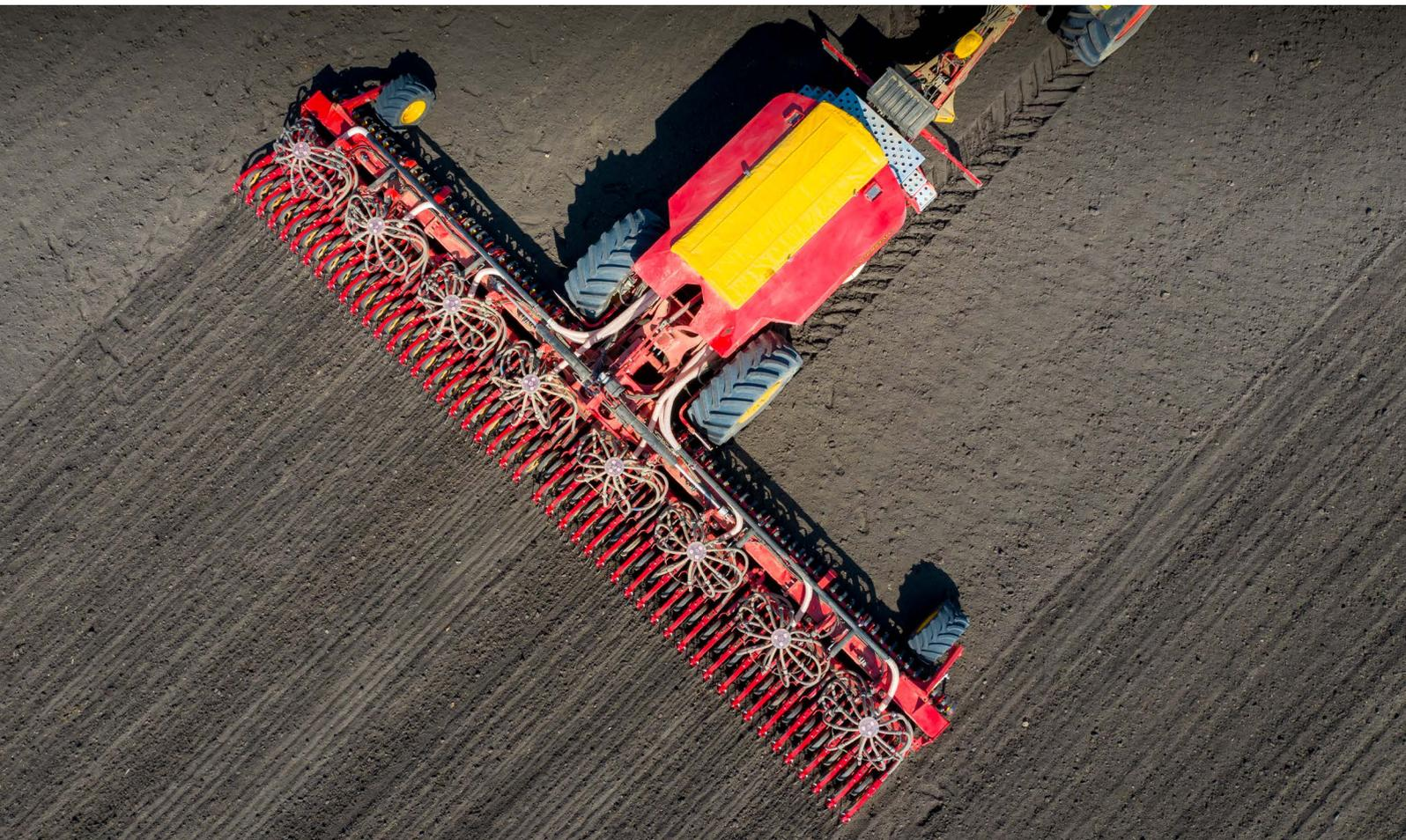
Inspire 1200C/S оснащена большим бункером с низкой высотой загрузки и большим люком. Версия Inspire 1200S, предназначенная только для семян, оснащена бункером для семян объемом 5000 литров. В то время как комбинированная версия Inspire 1200C оснащена бункером объемом 7200 литров, в котором семена и удобрения находятся в двух отдельных отсеках. Благодаря большой платформе и открытой конструкции вы получаете хороший доступ ко всем узлам машины.
