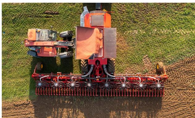
*Большой бункер и его малая высота обеспечивают легкую загрузку.*
