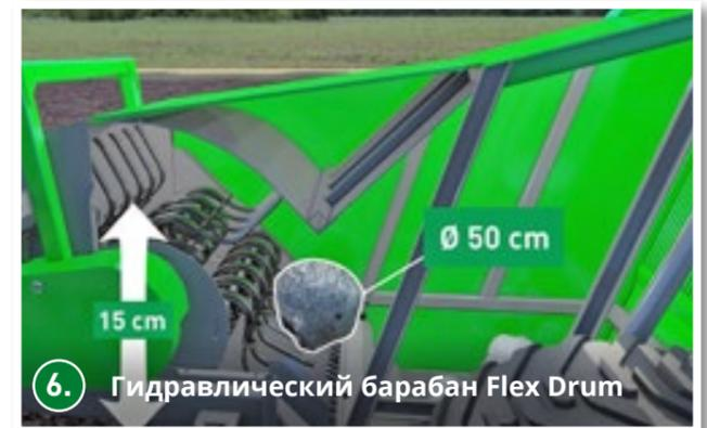
6. Гидравлический барабан Flex Drum
